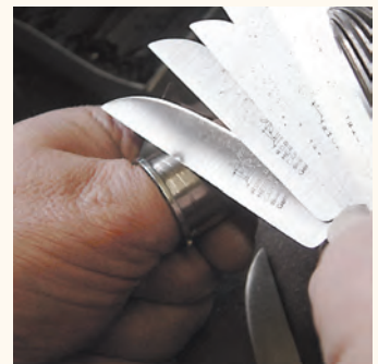
Nagel - oder Ringprobe Ohne diese Kontrolle verläßt kein Messer unsere Fertigung.
