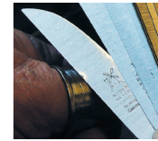
Klingenkontrolle auf dem Ring – „Nagelprobe“
