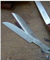
Klinge mit „Solinger Dünnschliff“
